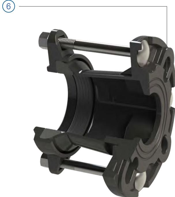
Муфты серии SMART являются стандартизированной продукцией с неизменными размерами и обеспечивают идеальное и быстрое соединение между трубами из любого материала с одинаковыми или различными внешними диаметрами до 327 мм. Фланцевые адаптеры имеют универсальную рассверловку PN 10/16.
