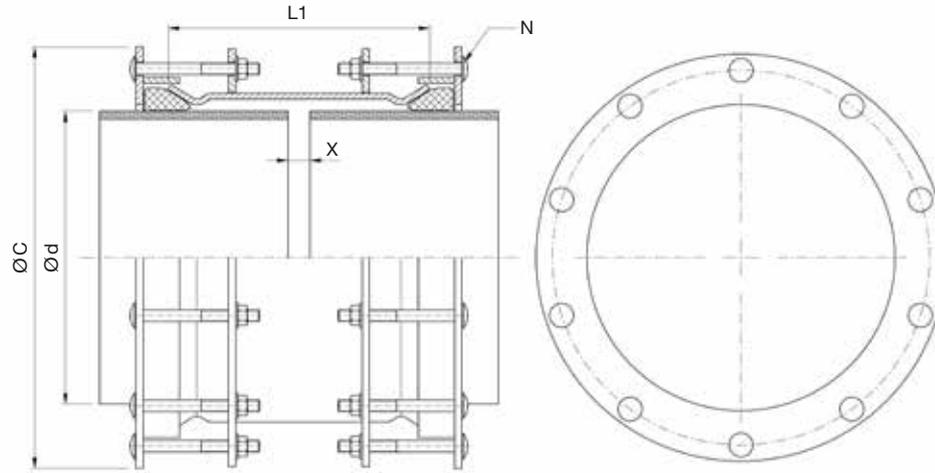
Multisize und Largesize Formstücke bieten eine maximale hydraulische Abdichtung, und schränken die axiale Bewegung von Rohren nicht ein (Weiteres zu diesem Produkttyp entnehmen Sie bitte dem Abschnitt MULTIGRIP). Andere Größen oder Längen auf Anfrage
