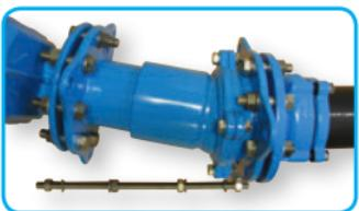
**ATENCIÓN:** observar la dirección de montaje del juego de protección de tracción. El lado bombeado debe estar orientado hacia adentro en todas las arandelas esféricas.
