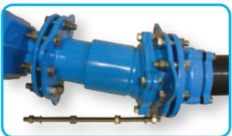
**ATTENTION :** respecter le sens de montage du kit anti-traction. La face bombée de toutes les rondelles sphériques doit être tournée vers l'intérieur.
