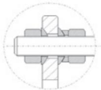
3. Die weiteren Gewindestangen wie oben beschrieben einführen und die Kugelscheiben und Muttern lose verschrauben.
