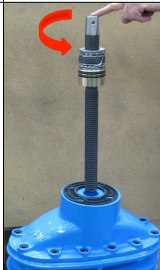
6. Auf neuer beschichteter Spindel das Kugellager und den O-Ringträger montieren (Reihenfolge wie Originalspindel). Spindel in Keilmutter durch linksdrehen einschrauben.
