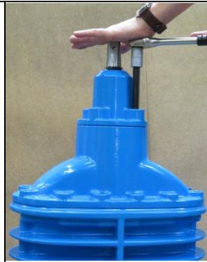
2. Innensechskantschrauben lösen und entfernen.
