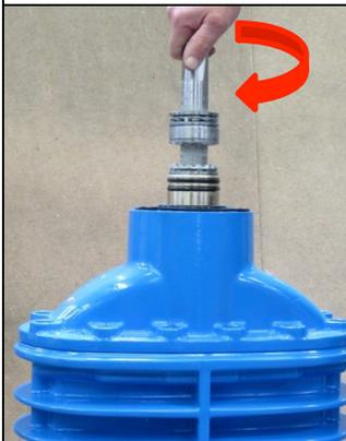
5. Spindel mit Kugellager und O-Ringträger durch rechtsdrehen aus dem Schieber herausschrauben.
