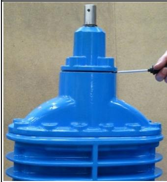
3. Zentrierflansch entfernen
