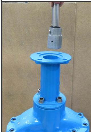
7. Spindelmuffe mit Zapfen auf Spindelvierkant aufsetzen.
