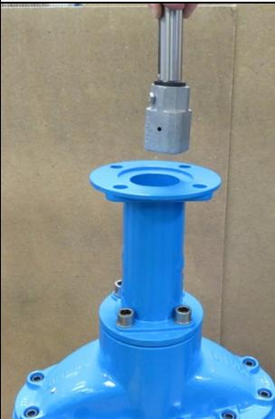
7. Spindelmuffe mit Zapfen auf Spindelvierkant aufsetzen.
