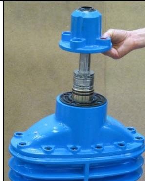
4. Falls das obere Kugellager oder ein Lagerring im Zentrierflansch verbleibt, ist diese herauszunehmen.
